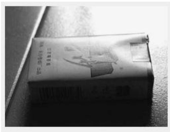
使用偏振片前有严重的反光影响检测
